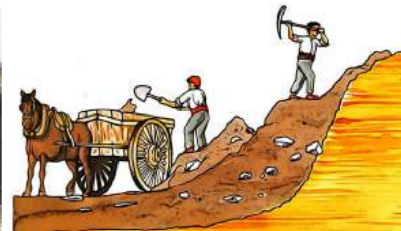
1. La couche de terre et de roches recouvrant le minerai, le "stérile" est évacué.
