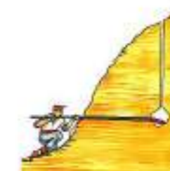
4. De l'explosif en plus grande quantité est disposé dans la chambre.
