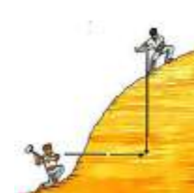
2. Deux trous très profonds sont pratiqués à la barre à mine et au foret.
