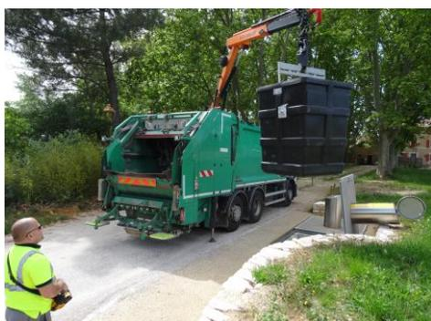
Le SIRTOM a opté pour ce mode de collecte polyvalent avec une benne traditionnelle équipée d'une grue auxiliaire qui permet à la fois de collecter les conteneurs aériens et ceux qui sont enfouis.
