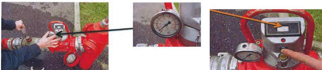
8. Poursuivre l'ouverture de la vanne de l'appareil de mesure
