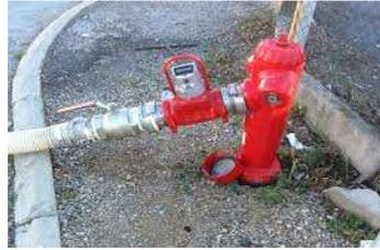
9. Fermer lentement l'hydrant puis démonter l'appareil de mesure.
