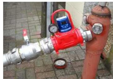
7. Manœuvrer la vanne de l'appareil de mesure pour faire « tomber » la pression dynamique à 1 bar
